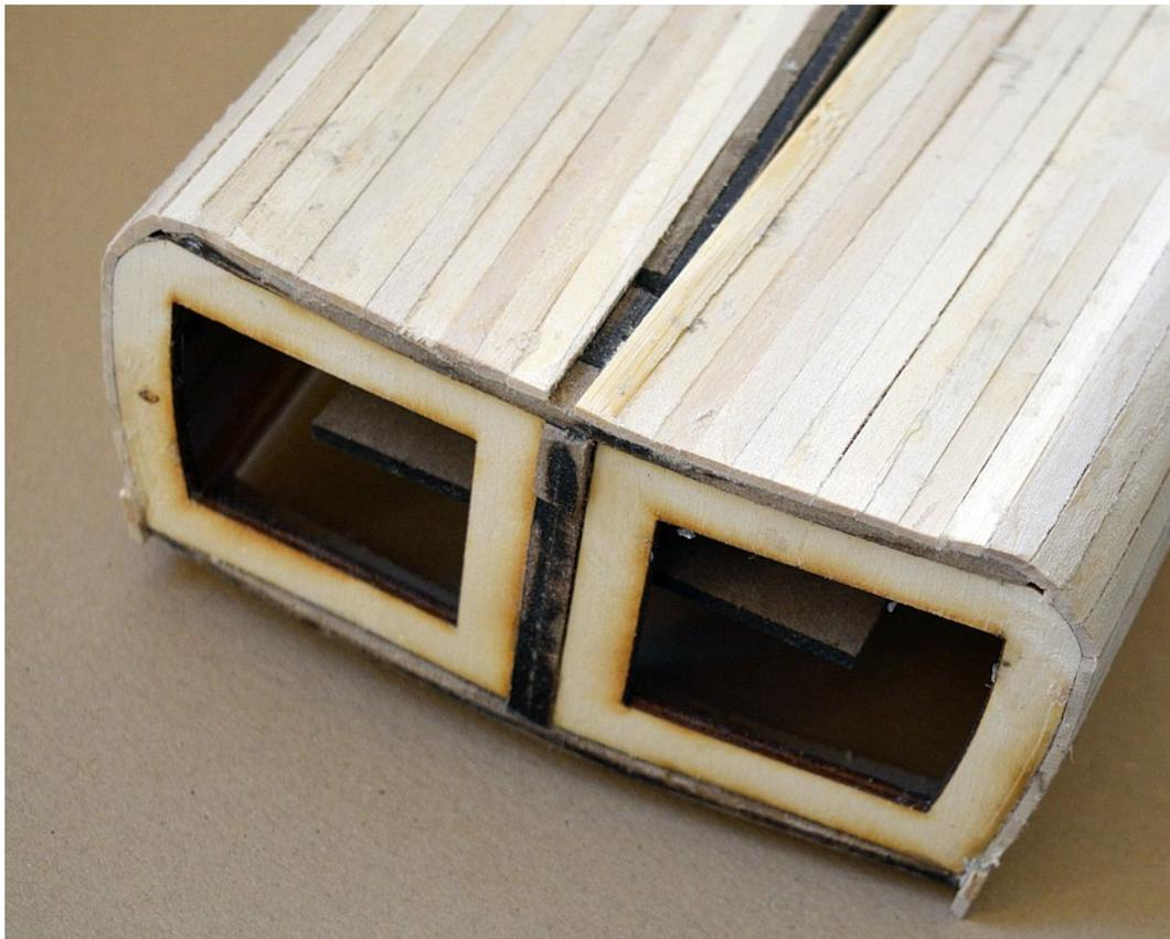
*Abbildung 10: Beplankung am Heckspiegel*
